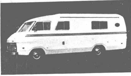
Xplorer 307 型房車，特色為其車身結構，廣泛使用玻璃強化塑膠材料。(Xplorer Motor Home Div., Frank Industries, Inc., Brown City, Mi)
