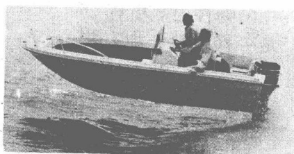
MFG fishin' Caprice, 18 英尺 2 ½ 英寸長之外弦艇，由玻璃纖維強化聚酯樹脂製成。(Molded Fiber Glass Boat Company Union City, pa.)
