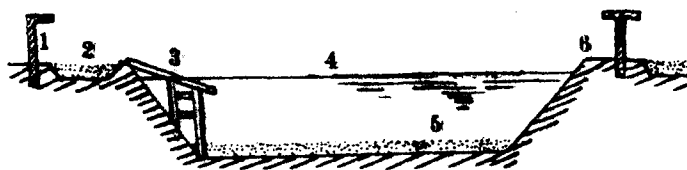
图2. 土质亲鳖池断面图
