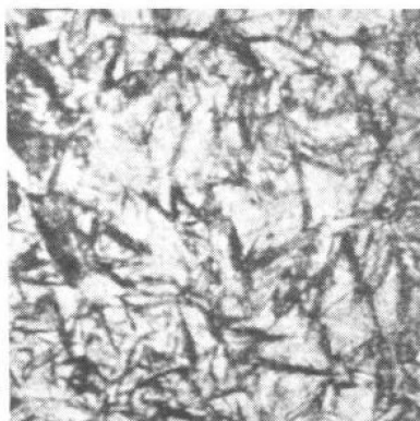
圖 4 0.4% C 碳鋼全硬化（放大直徑 50 倍）材料之結晶構造是麻田散鐵，其硬度是 600 Brinell。
