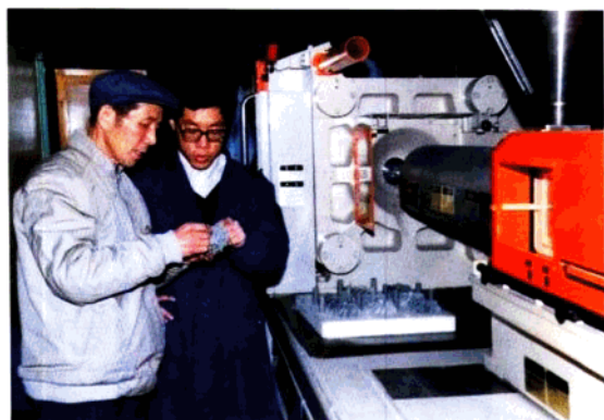
指导博士生张锡明（现在美国任职）进行氮化硅陶瓷制作发动机涡轮叶片的注射成型新工艺及有关机理研究
