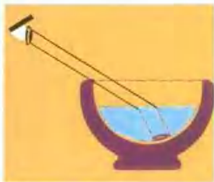
種顯示光的折射現象之實驗
