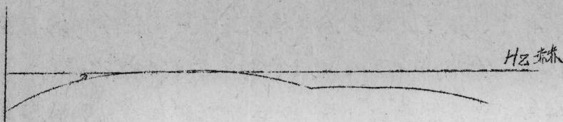
频率响应、1、带式传声器的典型响应。这个频率响应大体是平的，在高频略有损失。有此损失 频率与传声器尺寸有关。
