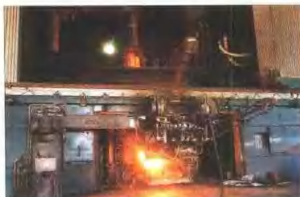
100吨超高功率直流电弧炉在冶炼中
