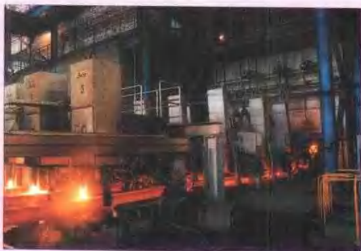
大方坯三机三流弧形连铸机生产过程中
