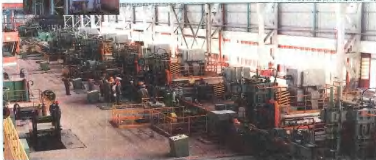
年产30万吨合金钢棒材连轧生产线
