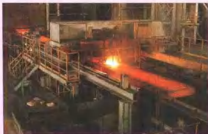
1900mm大型板坯连铸机正在拉坯
