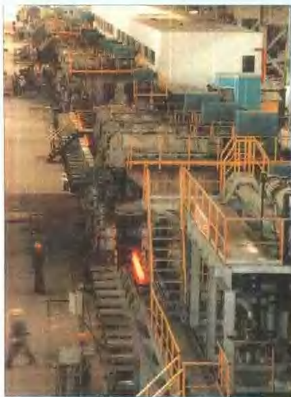
意大利引进24架合金钢全连轧生产线
