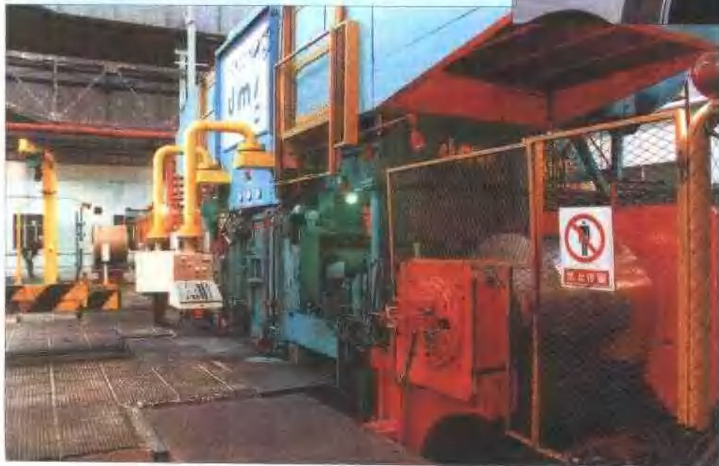
从法国引进的硅钢 ZR22B52 型森吉米尔轧机
