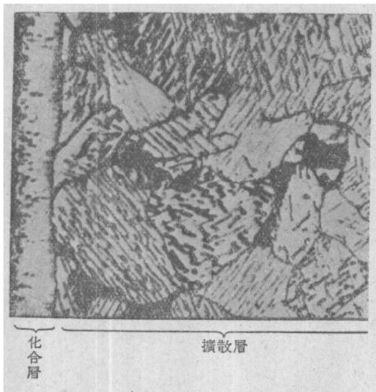
图 4 碳素钢(0.15%C)经 1050°F(570°C)氮化 90 分钟，并在 575°F(300°C)回火 60 分钟。回火在实际生产中并不需要；回火后在铁素体基体中析出针状 Fe 4 N。
