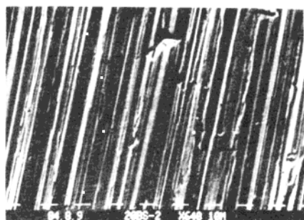
图9 C - 2 钢磨损表面的S E M照片
