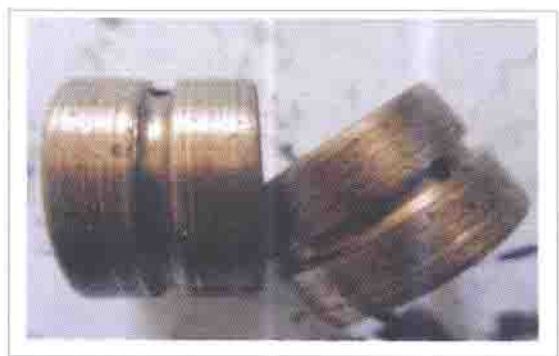
因机油杂质引起的增压器转轴和轴承拉伤而松旷，导致叶轮擦壳、增压器损坏
