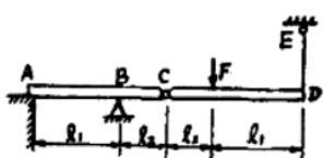
端  $D$  以铅垂细绳  $DE$  挂起，在梁  $CD$  上作用已知力  $F$ ，求铰链  $A$  的反作用力，支点  $B$  的反作用力及绳  $DE$  的张力。
