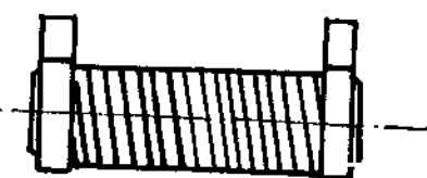
(丁) 圆柱形基体单层平绕线绕电阻器
