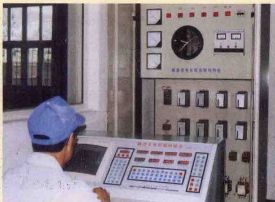
▲ 实验车间自行研制的牵引电机、辅助发电机实验台在出口车生产中发挥了重要作用。
