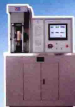
MMU-5G 高速端面摩擦磨损试验机
