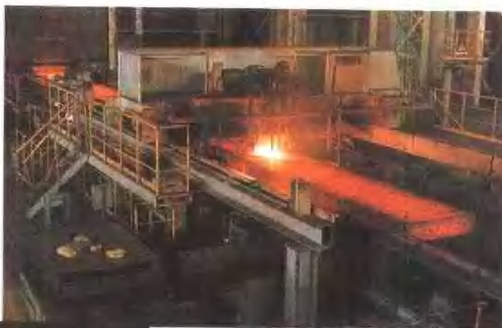
1900mm 大型板坯连铸机正在拉坯
