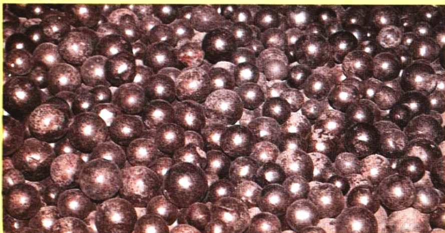
该厂耐磨铸铁球，经 2.2 \times 6.5 米水泥磨机 使用后，球的破损率低于 3%，磨耗低于 300 克/吨
