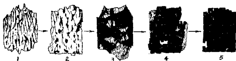
图 12 混合岩中磁铁矿交代角闪石演化图
