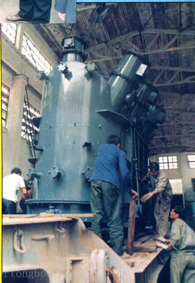
待运中的大型变压器
