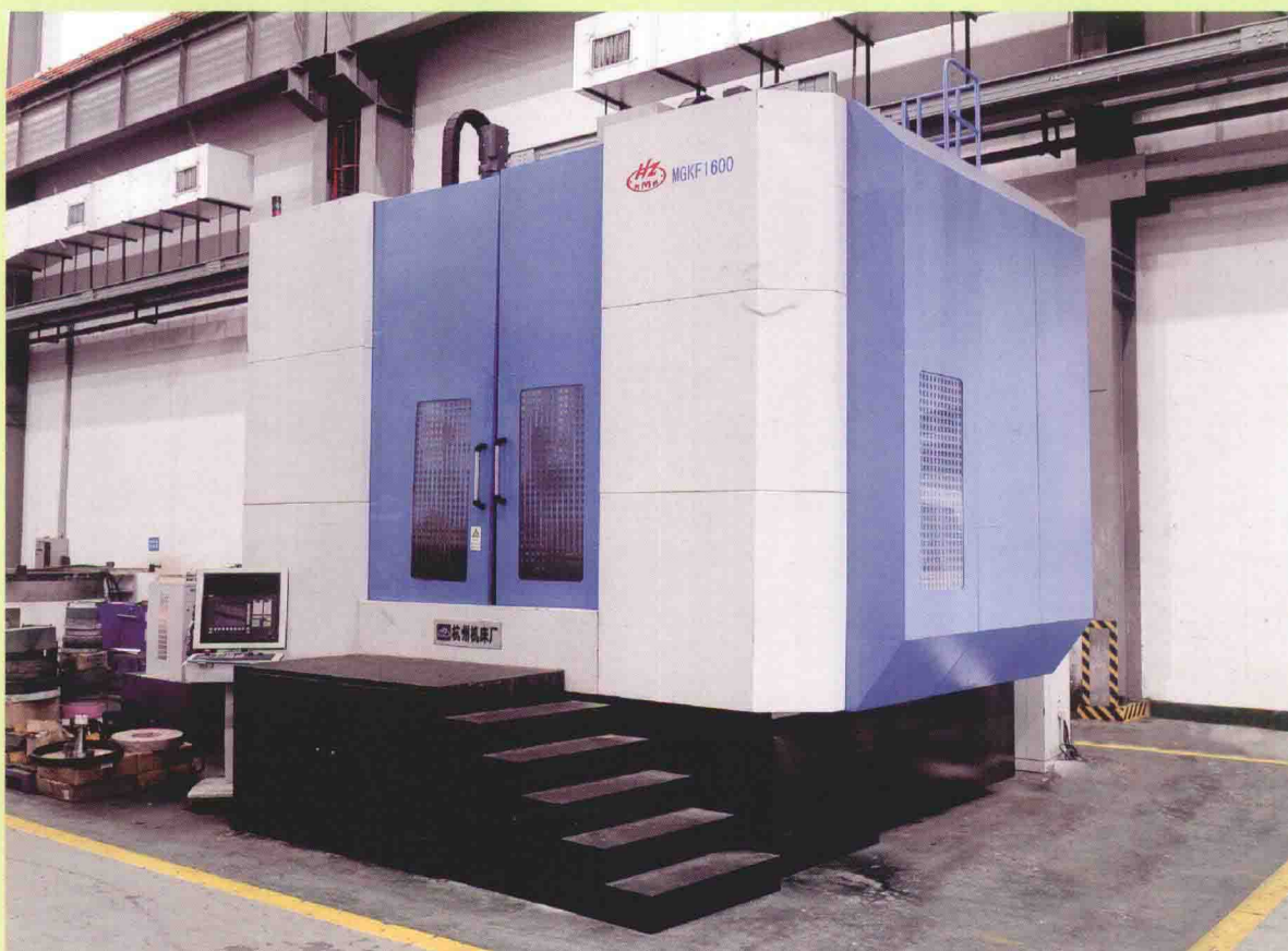
MGKF1600/1高精度数控立轴复合磨床
