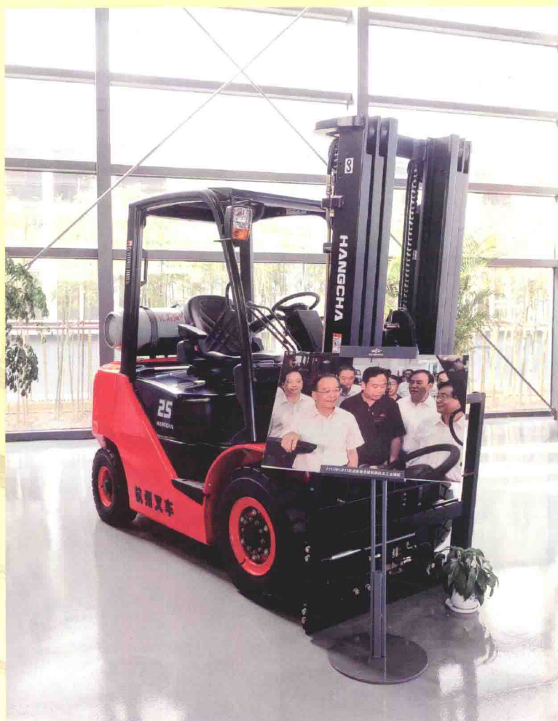
新一代XF节能环保型内燃平衡重式叉车
