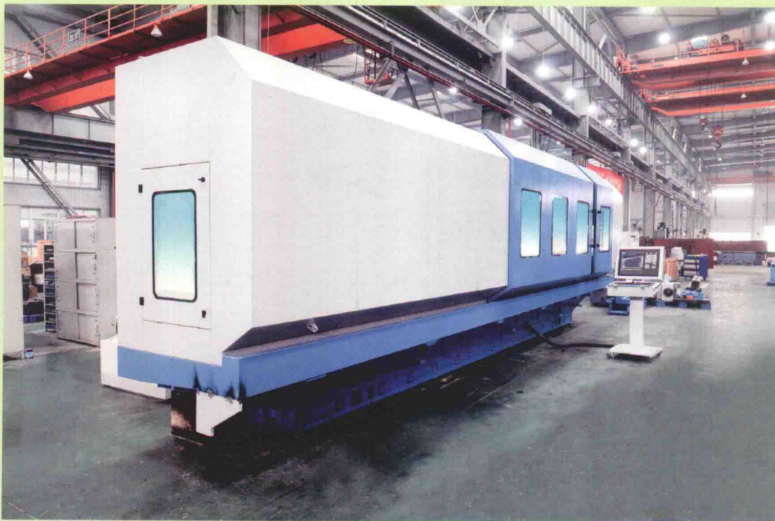
MKC7150×50型精密数控剪刀成形磨床
