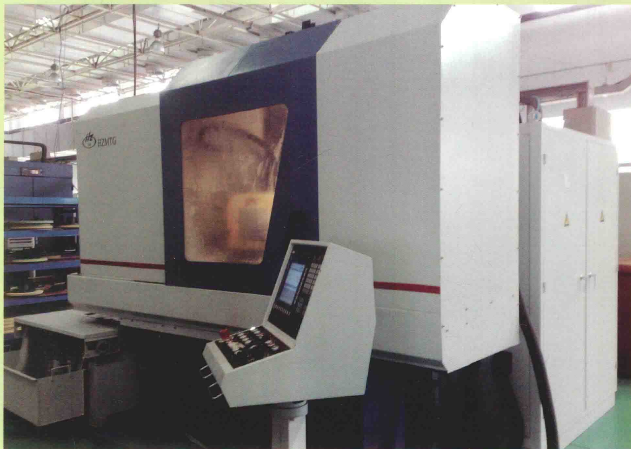
MKL7132×8/2鼠牙盘端面齿数控强力成形磨床
