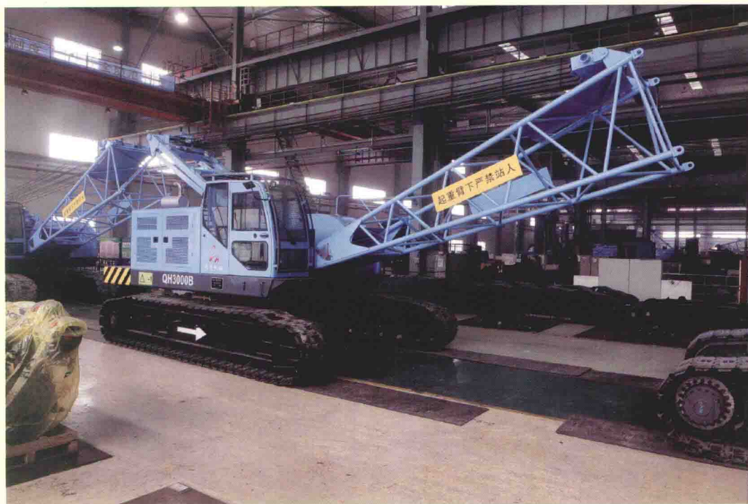
机液一体式大型履带（强夯）起重机
