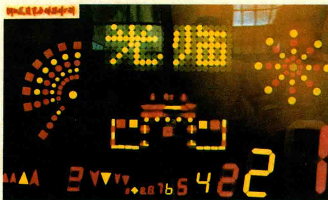
慈溪半导体器件厂生产的磷砷化镓半导体发光器件。
