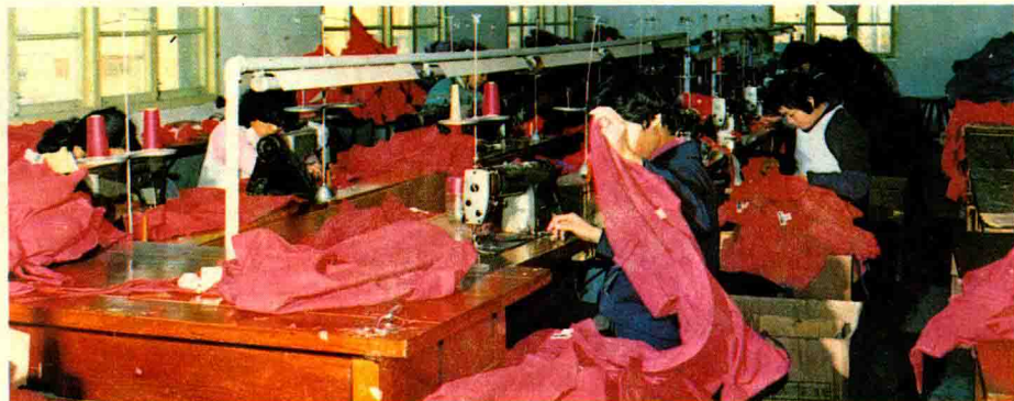
宁波市纺织服装五厂生产线一角。其主要设备平缝机系从日本引进。
