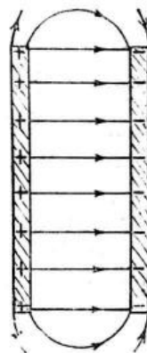
图1—6 两个带有异种电荷的平行金属板间的匀强电场
