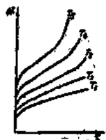
图3 温度对恒定应力下蠕变曲线形状的影响：
