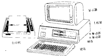
图 1-1 IBM-PC/XT 的硬件组成
