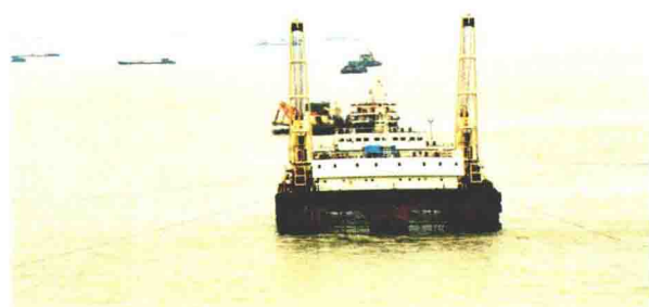
首创的基床抛石整平船，日最高抛石 6000 m 3 ，整平 1620 m 2 。
