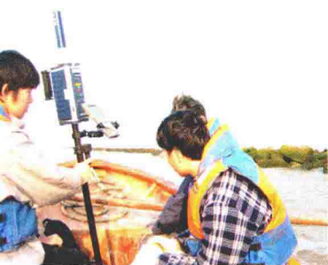
GPS 检测堤顶标高
