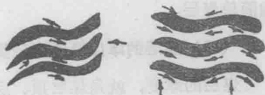
图1—11 构造变动使煤层发生变化
