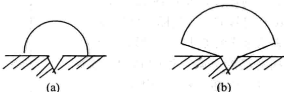
图 2 沸腾泡核的长大
