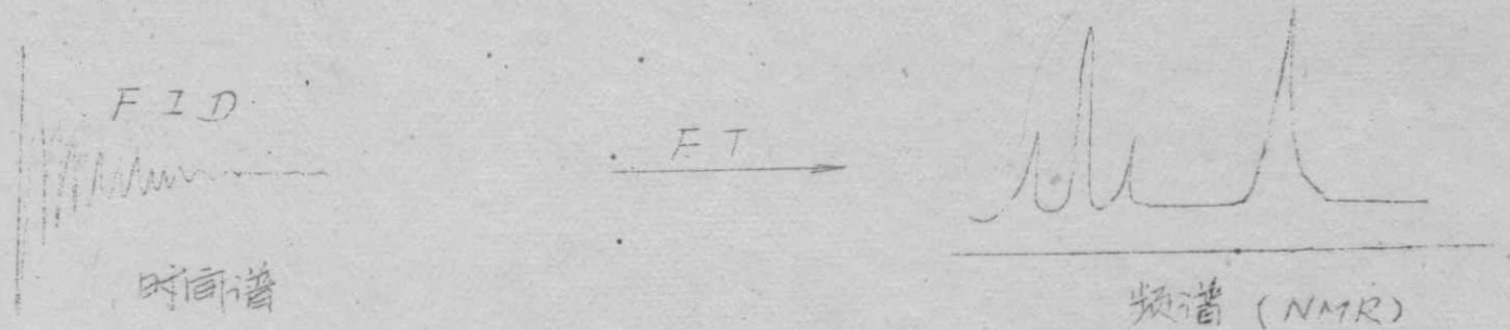
图 5-3 脉冲付里叶变换核磁共振工作原理
