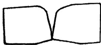
图2 钢坯焊接时的正确位置
