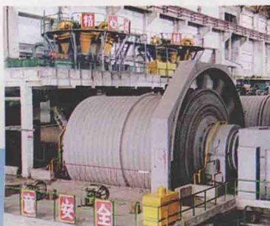
△ \varnothing 5.03 \times 6.4 米溢流型球磨机单机日处理矿石 5000 吨。
