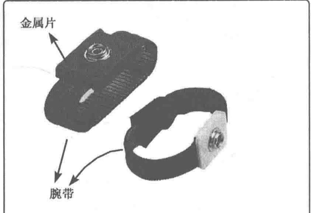
师傅：这是无线防静电手环，腕带内层由数十匝不锈钢纤维织成，并与使用者的手腕全面接触；腕带外层由尼龙和橡胶带织成，使腕带能与使用者的皮肤保持松软接触。利用腕带内层金属将人体静电传递至金属片，通过内置电阻释放掉。无线防静电手环的防静电效果不如有线的好。
