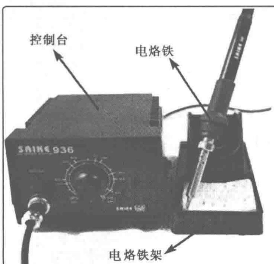
师傅：这是赛克936型防静电恒温电烙铁，它包含控制台、电烙铁及电烙铁架三部分，主要特点如下：
