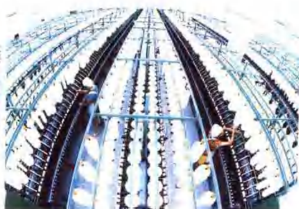
南通第三棉纺织厂 1992 年设备更新后的 FA507 细纱机(国产先进设备)
