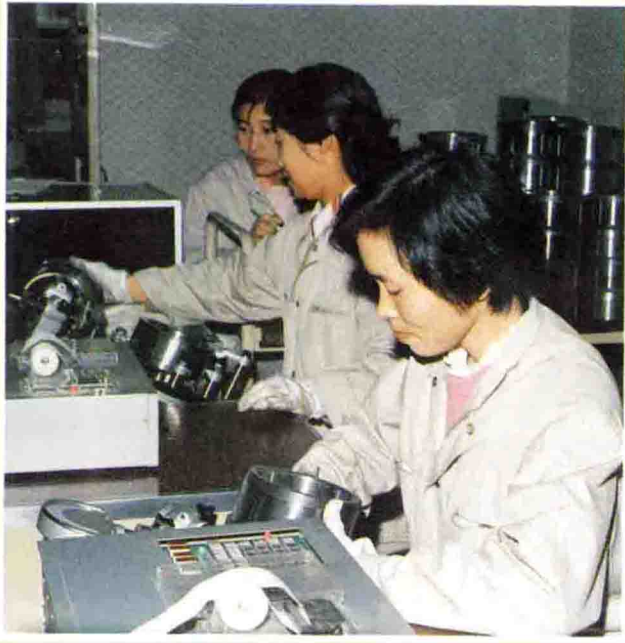
用小位移自动测量仪检测轴承
