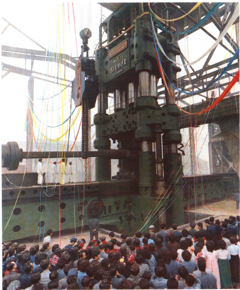
龙城机械联合企业的工人们用一年多一点的时间 制造的一万吨水压机。
