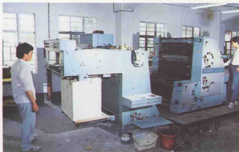
▷ 恩平县印刷装璜公司引进的百花 RZ120C 型对开双色胶印机。
