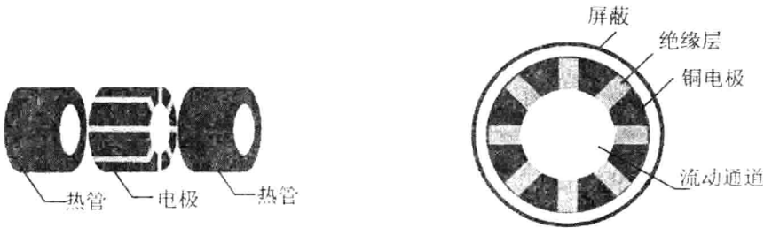
图 6. 铜管脉动热管 ECT 传感器
