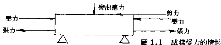
圖 1.1 試樣受力的情形
