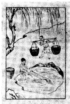
图13 宋应星《天工开物》中的洗矿图
