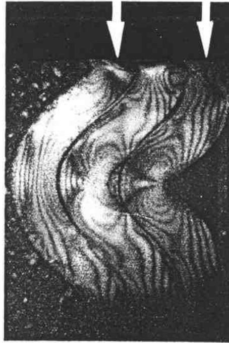
b. 明胶标本纵弯曲时的干涉色条纹 (在双偏光镜下)
