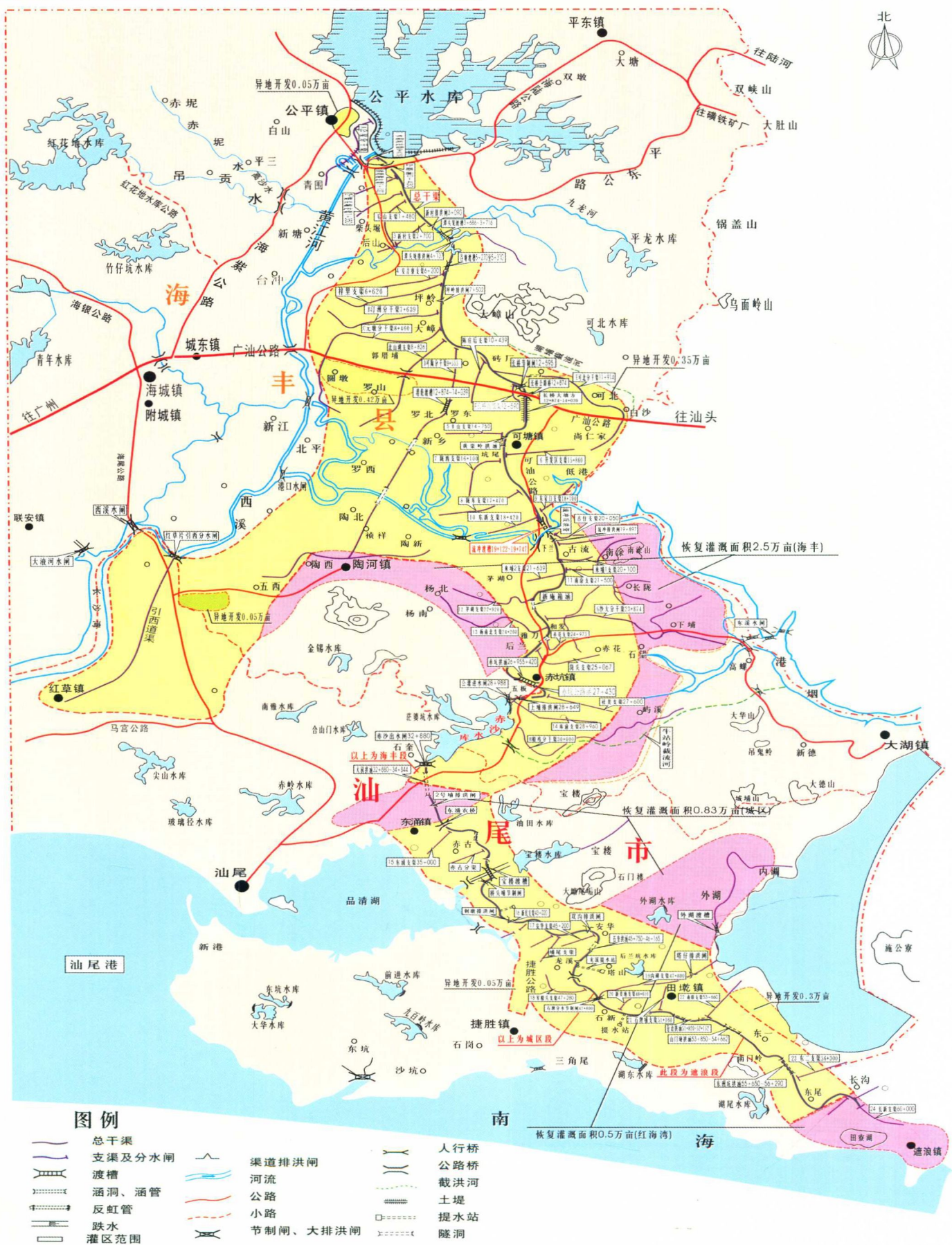
公平水库灌区工程总平面布置示意图
