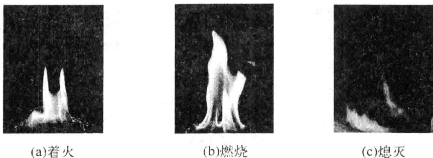
图2 乙醇浸没在沙子中燃烧时的三个过程
