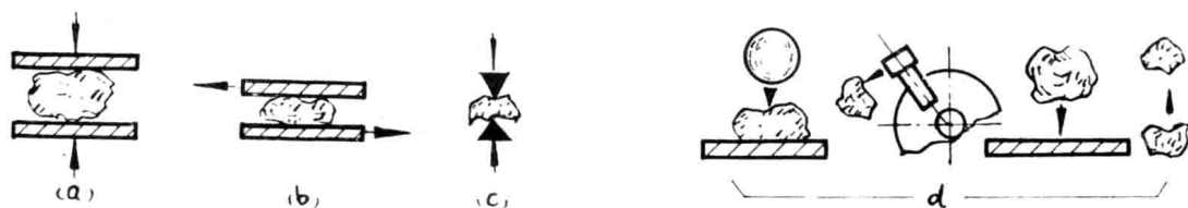
图 1—1 物料破碎的方式
