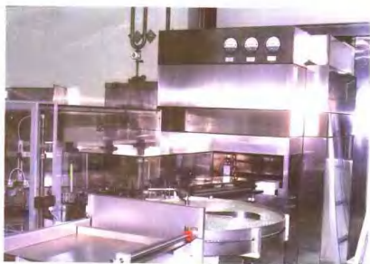
自动清洗与分装 系统 Automatic washing and filling system
