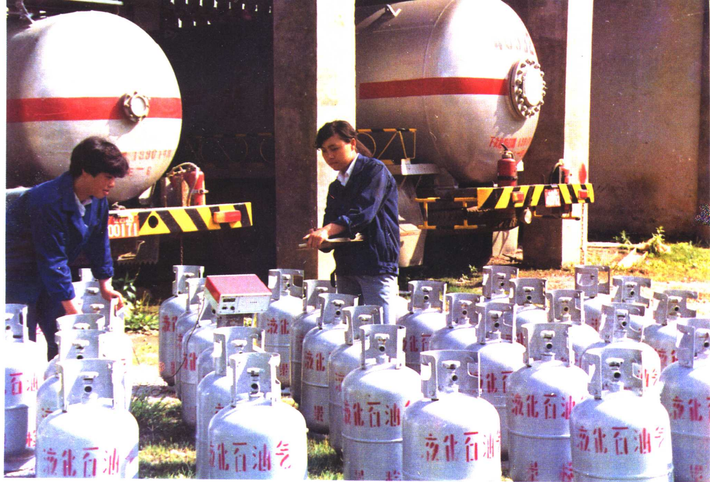
压力容器安全检验人员在检验钢瓶
