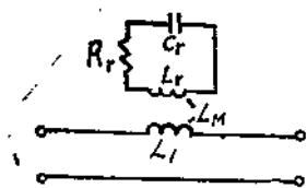
图3 在耦合平面处的等效电路
