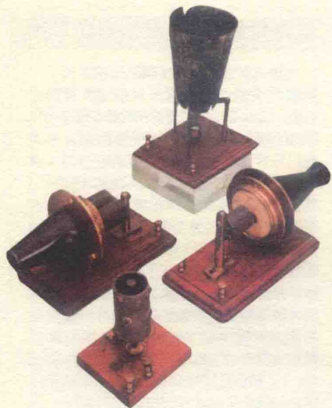
上图展示的是贝尔的电话机。最左与最右的是电话受话机和送话机，其他是送、受话机的零件。从这个时候起，不但是美国，世界的通信史也大大地改变了。
