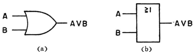
图2.6 两输入端“或”门的逻辑符号
