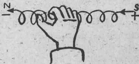
圖1—11 螺旋綫卷中電流方向和磁力綫方向的关系
