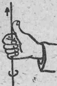
圖1—10 導線中電流方向和磁力綫方向的关系
