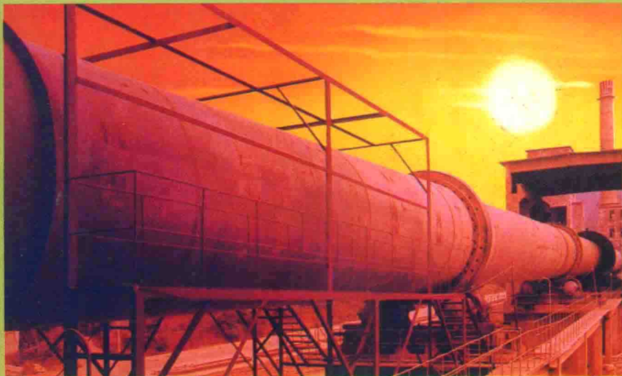
梅州市塔牌集团公司建成的 年产 60 万吨回转窑生产线 (市经委供稿)
