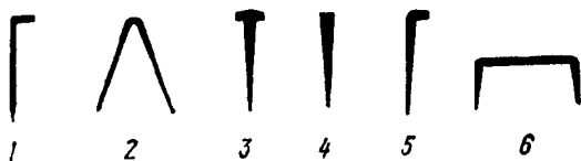
图14 用边角废料自制的铁钉
