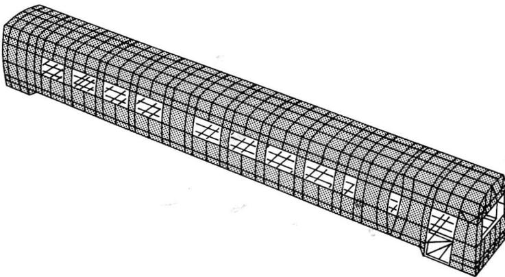
**Bild 0.3.** Finite-Element-Modell für den Wagenkasten eines Reisezugwagens (Werkbild DÜWAG, nach [0.13])
